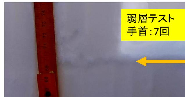
矢印:破断面、雪が飛び出した感じ
